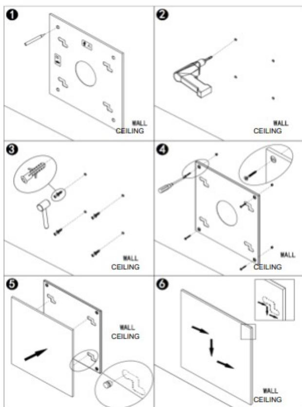
**Pastaba:** komplekte esantys montavimo elementai yra skirti montavimui ant sienos stabiliu paviršiumi. Jeigu norite montuoti ant kito paviršiaus, jums reikia tam tinkamų montavimo elementų.
